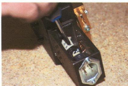
Lösen Sie jetzt die 4 seitlichen Halteschrauben in der Grundplatte. Diese ist jetzt lose.
