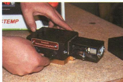
Entnehmen Sie die Brennplatte vorsichtig und lösen Sie die fünf Klemmschrauben.
