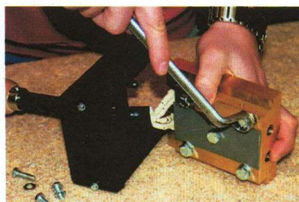
Ziehen Sie die Heizpatronen heraus und setzen die neuen Heizpatronen ein. Bauen Sie den Brennkopf in umgekehrter Reihenfolge wieder zusammen.
